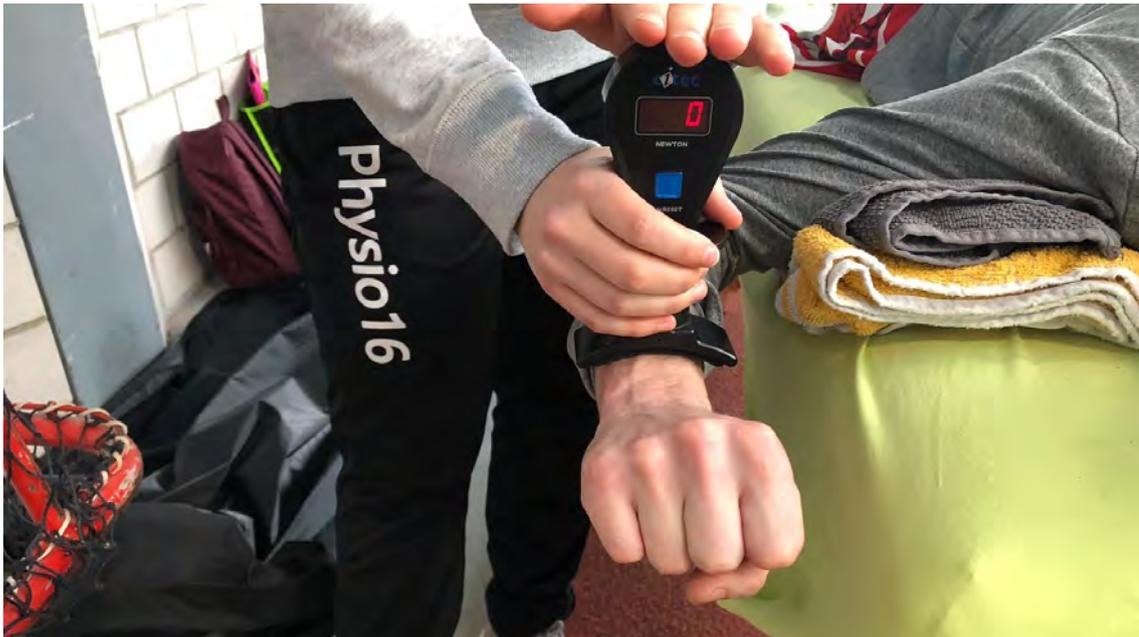
Abbildung 18: Isometrische Kraftmessung der Aussenrotatoren der Schulter mit dem Citec Handheld Dynamometer in der von den Autorinnen definierten Ausgangsstellung
