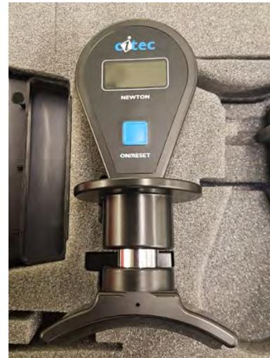
Abbildung 17: Citec Handheld Dynamometer mit Arm-Applikator
