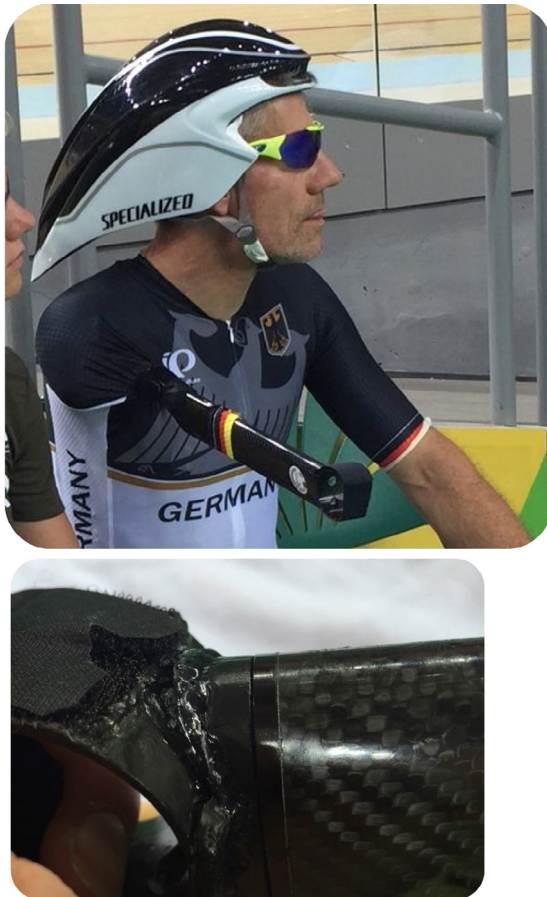
Abbildung 2 Bruch des Carbon-Interfaces „zum Griff“ bei einem Oberarmamputierten paralympischen Bahnradsportler.
